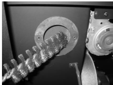
Figure 82 – a) Aspirez l'intérieur ; b) Nettoyez avec un écouvillon
