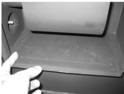
Figure 79 – Nettoyage de l'intérieur du poêle
