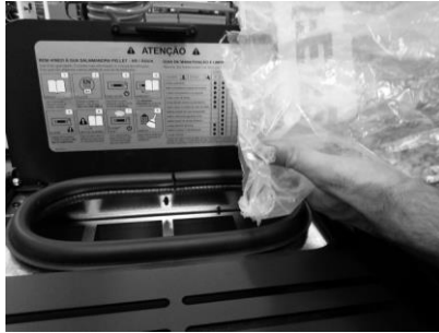
Figure 71 – Réapprovisionnement du réservoir à granulés
