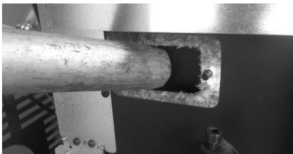
Figure 83 – a) Aspirez l'intérieur ; b) Nettoyez avec un écouvillon
