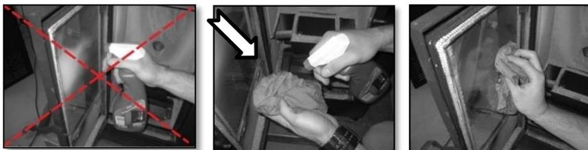
Figure 44 – Exemple de méthode de nettoyage de la vitre
