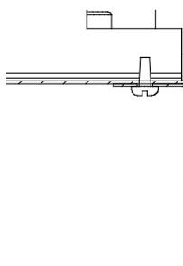
La fixation des 2 cadres latéraux avec le cadre supérieur a lieu à l'aide de 2 vis par côté.
