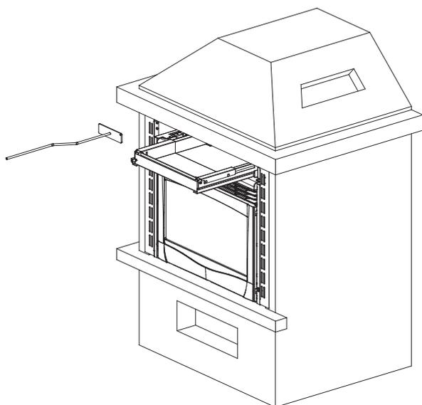
Le kit en option de chargement du pellet permet de charger frontalement le pellet à l'intérieur du réservoir sans être obligés d'extraire l'insert (une opération qui demande l'arrêt de la machine).
